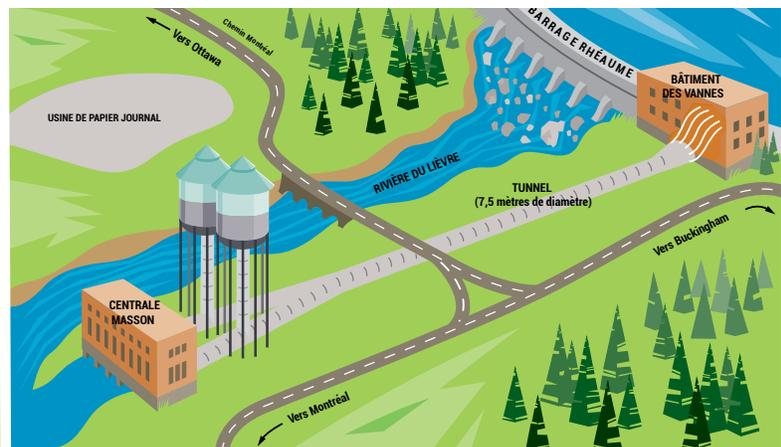
Lors d'un arrêt soudain de la centrale de Masson, l'eau ne peut plus passer dans le tunnel et doit passer à travers le barrage. L'eau arrive rapidement et avec force dans le lit de la rivière.
